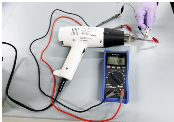
焦電材料による温度変化発電実験
